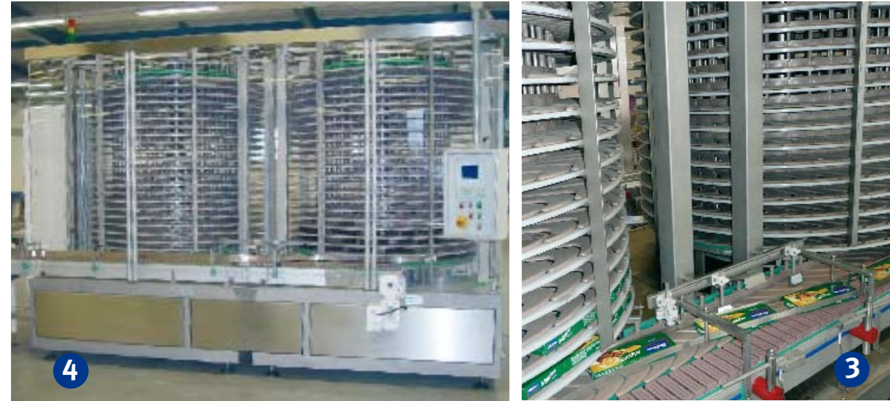
Der HELIFLEX-Speicher zeichnet sich durch die kompakte Bauweise selbst auf engem Raum aus
