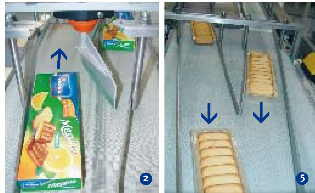
Die elektrische Weiche leitet die Produkte bei Bedarf automatisch in den HELIFLEX- Speicher
