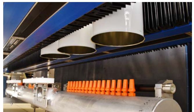
Verstärkter Reinigungseffekt: Eine zentrale Höhenverstellung der Ausblaslanze ermöglicht, dass die Distanz zwischen Produktmündung und Ausblaseinheit variiert werden kann.
