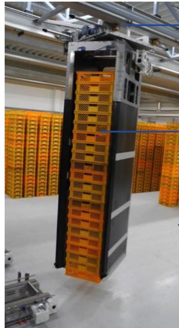
Der Transport der Korbstapel erfolgt von oben über eine Fahrbahnbrücke. So ist der Boden frei von Fördertechnik und lässt sich sehr gut reinigen.
