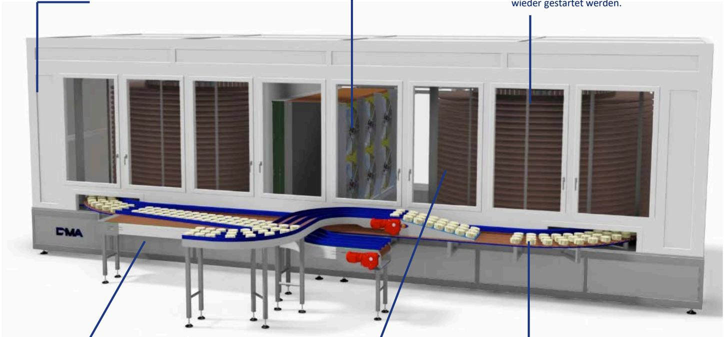
Durch Stellfüße werden Unebenheiten im Boden kompensiert. Die Getriebe der Anlage befinden sich außerhalb der Kühlzelle, sodass hierdurch keine Wärme in das System gelangt.
