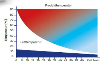
Produkte werden schnell, effizient und vor allem alle gleich auf die gewünschte Temperatur abgekühlt.
