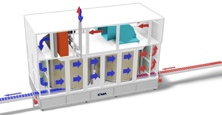
Der konstruktive Aufbau der DMA HELIFLEX- Kühlsysteme ermöglicht eine im Vergleich zu Spiralkühlern besonders kompakte Bauweise.
