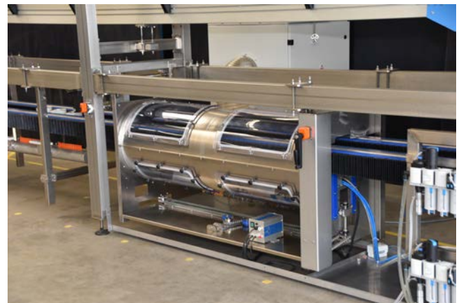
Linearrinser mit Klemmbackentechnologie: Gummilippen greifen die Produkte schonend von der Seite. Die Flaschen werden um 180 Grad gewendet und ausgeblasen.
